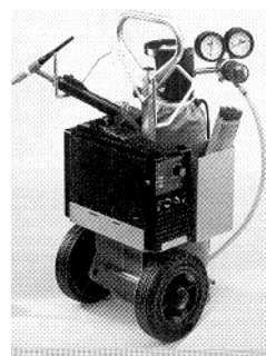
Wózek do wszystkich typów mocy. Z możliwością umieszczenia spawarki oraz 10-litrowej butli z argonem oraz uchwytem z możliwością jej wyciągnięcia.
